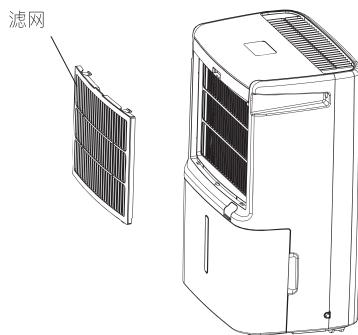
**注** 清理产品前，请将电源线插头从插座上拔除；清洗后，请将水箱安装回原位置，如果水箱未正确安装，机器将无法运转。
