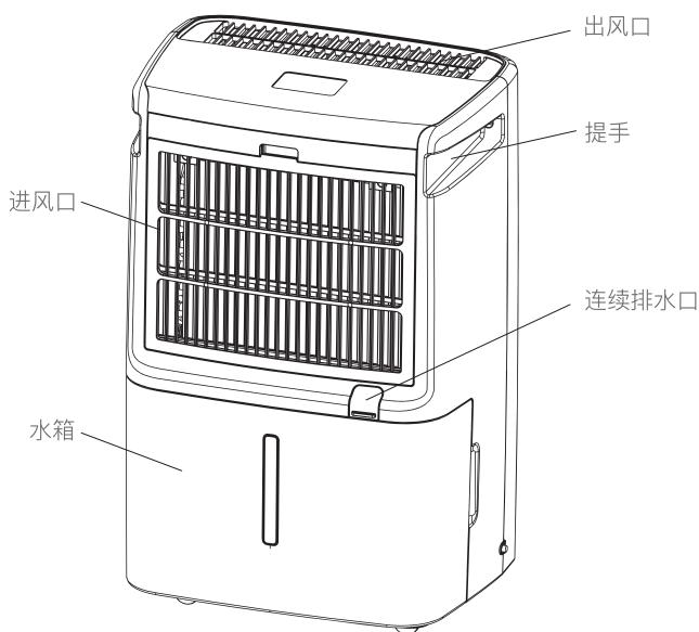
本产品已通过3C认证，采用蒸汽式制冷压缩原理，可高效去除空气中的水分。
