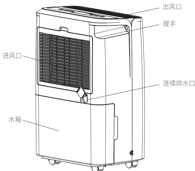
本产品已通过3C认证，采用蒸汽式制冷压缩原理，可高效去除空气中的水分。
