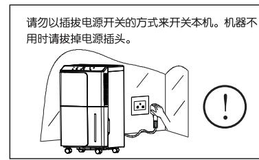
请勿以插拔电源开关的方式来开关本机。机器不用时请拔掉电源插头。
