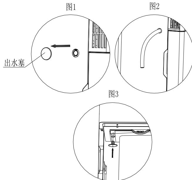
插入出水管时平顺展开，如果出水管缠绕或处于扁瘪状态会影响出水顺畅甚至造成机器不能正常工作。机器运行时水管亦不可高于机器出水口。
