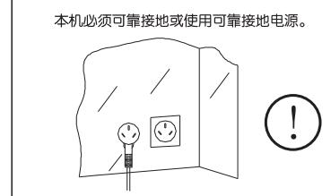
本机必须可靠接地或使用可靠接地电源。
