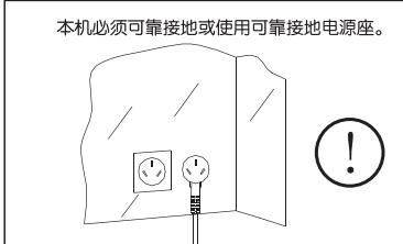
本机必须可靠接地或使用可靠接地电源座。
