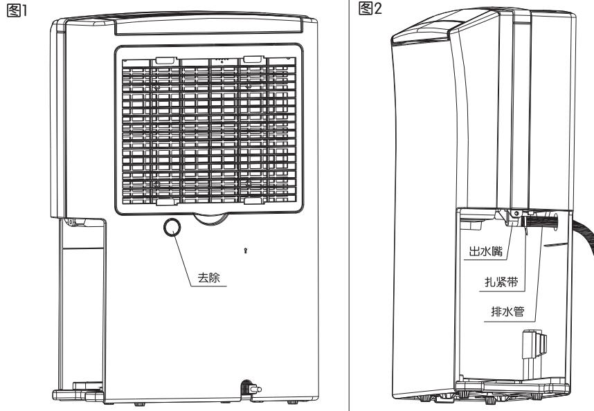
插入出水管时平顺展开，如果出水管缠绕或处于扁瘪状态会影响出水顺畅甚至造成机器不能正常工作。机器运行时水管亦不可高于机器出水口。
