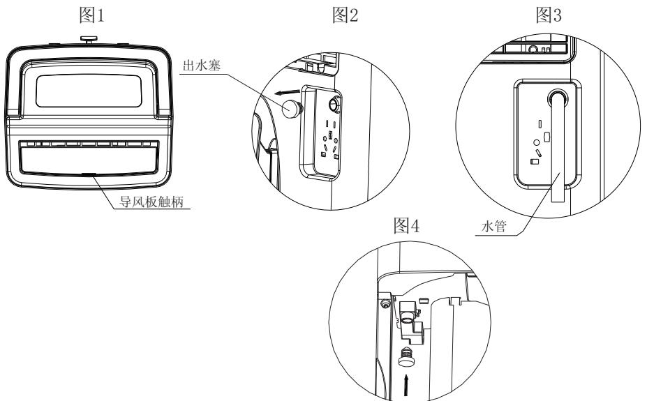
在机器启动前务必先打开出风导向板，以免影响机器性能并可能会对机器造成损坏。
